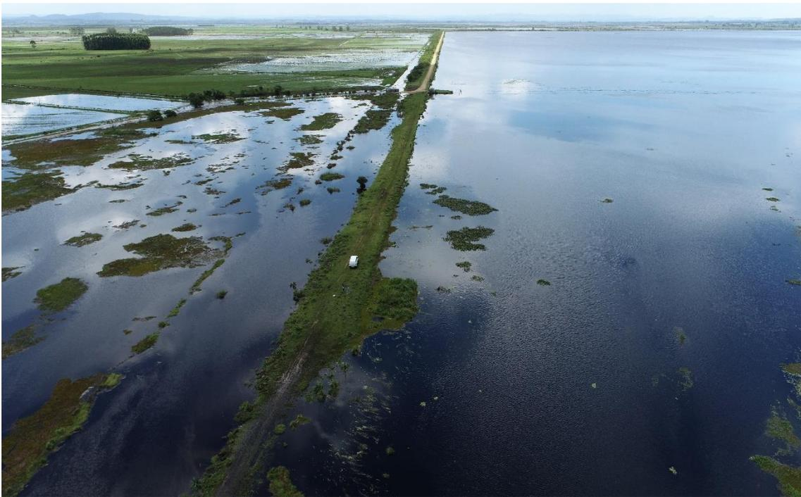
Figura 10: O rompimento causou o escoamento de água da direita para a esquerda na foto, resultando em prejuízos às lavouras e estradas vicinais.
