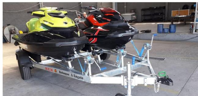
Reboque específico para transporte de duas motos aquáticas.
