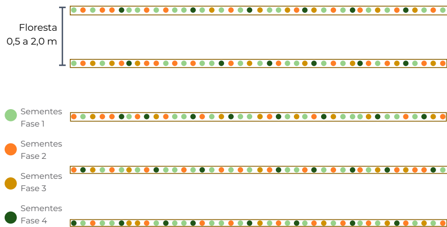
Figura 4: Esquema de distribuição de sementes das quatro fases, em linhas. As características das fases sucessionais e suas espécies dominantes estão descritas na seção Seleção de Espécies.
