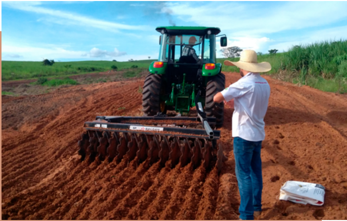
Figura 8: Preparo com grade aradora.
