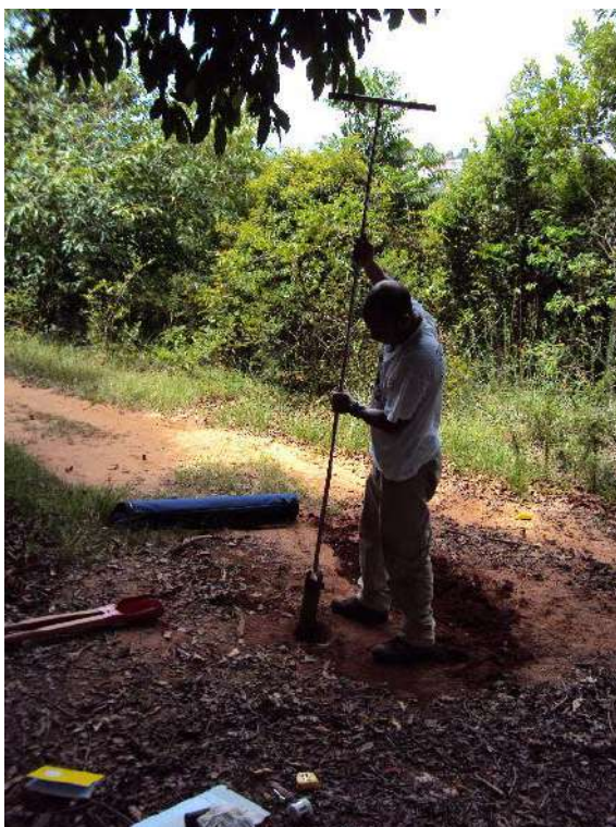
Figura 17 - Trado manual do tipo concha.
