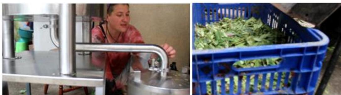
**Ajuste da pressão na fervura e trituração do material para o aumento a área superficial, facilitando a extração do óleo e hidrolato.**
