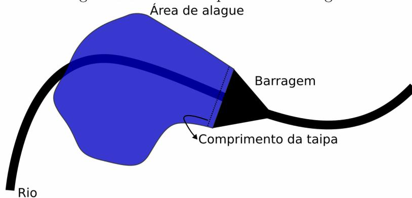
A altura máxima da taipa é medida do ponto mais baixo até o ponto mais alto da ombreira como mostrado na 3.9. Cuidado para informar valores de cota no lugar de altura, os campos altura da barragem e volume normal armazenado alteram o fluxo do processo no sistema.
